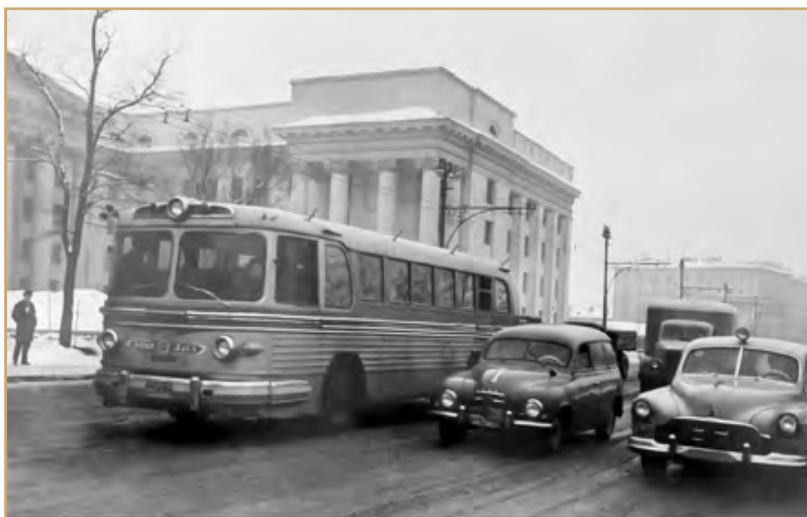
Автобус ЗИЛ-127 с газотурбинным двигателем «Турбо-НАМИ053 А1» на Ленинградском проспекте. Февраль 1960 г. Фото А. Сергеева-Васильева. Главархив Москвы, ЦГА Москвы. А-1 – 422
