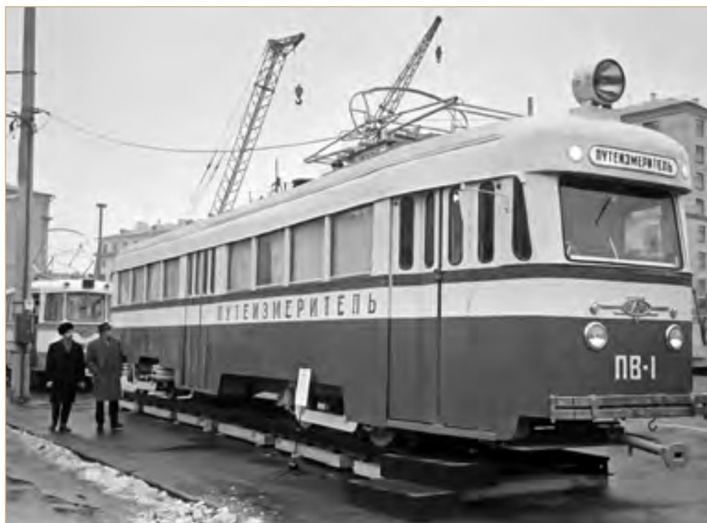
Трамвайный путеизмерительный вагон, изготовленный на Ленинградском вагоноремонтном заводе № 1, – один из экспонатов тематической выставки «Новая техника и передовой опыт в жилищно- коммунальном хозяйстве СССР» на ВДНХ. 17 ноября 1966 г. Фото Н. Кулешова. Главархив Москвы, ЦГА Москвы. А-0-1492
