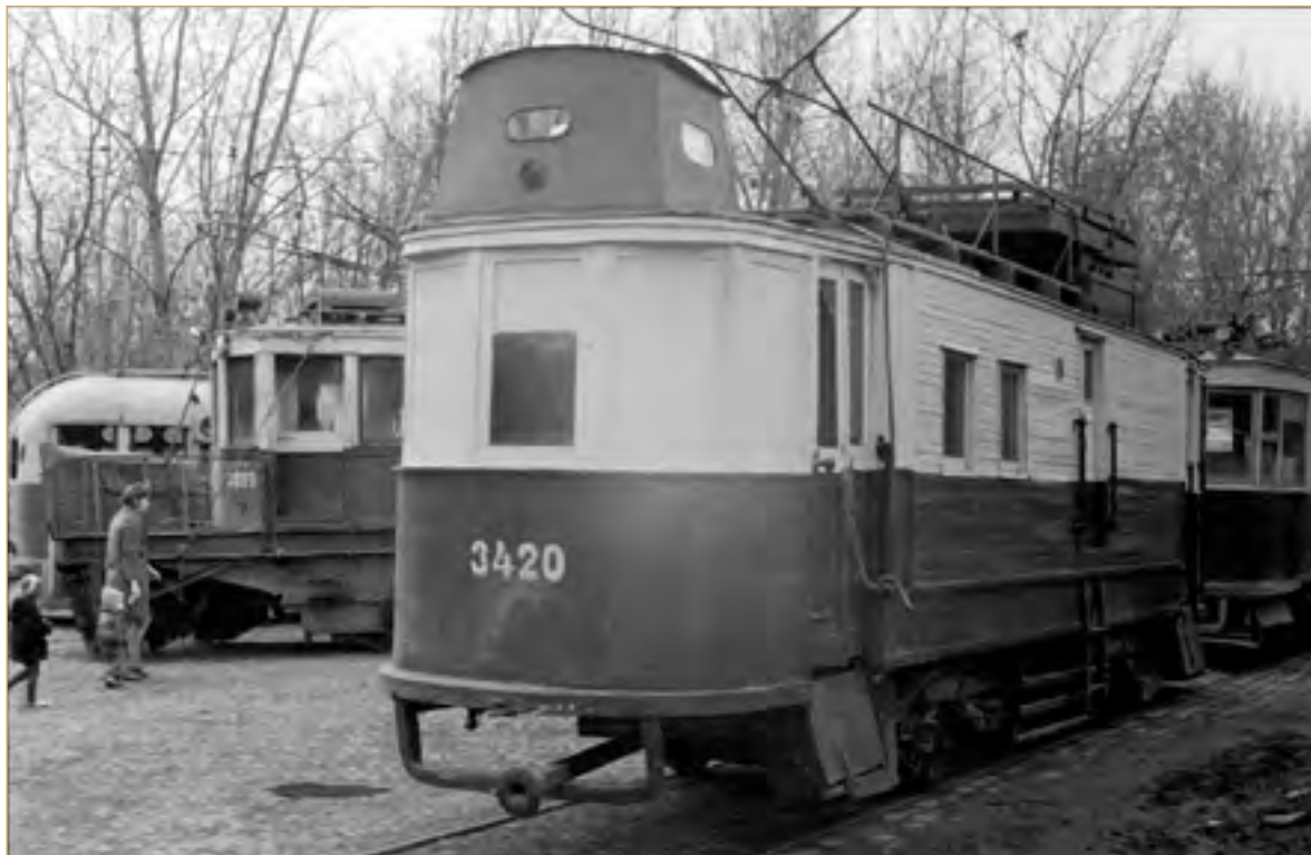
Специальный вагон по обслуживанию контактной сети на территории трамвайного депо им. И.В. Русакова. 1979 г. Фото М. Сорокина. Главархив Москвы, ЦГА Москвы. А-0–58174
